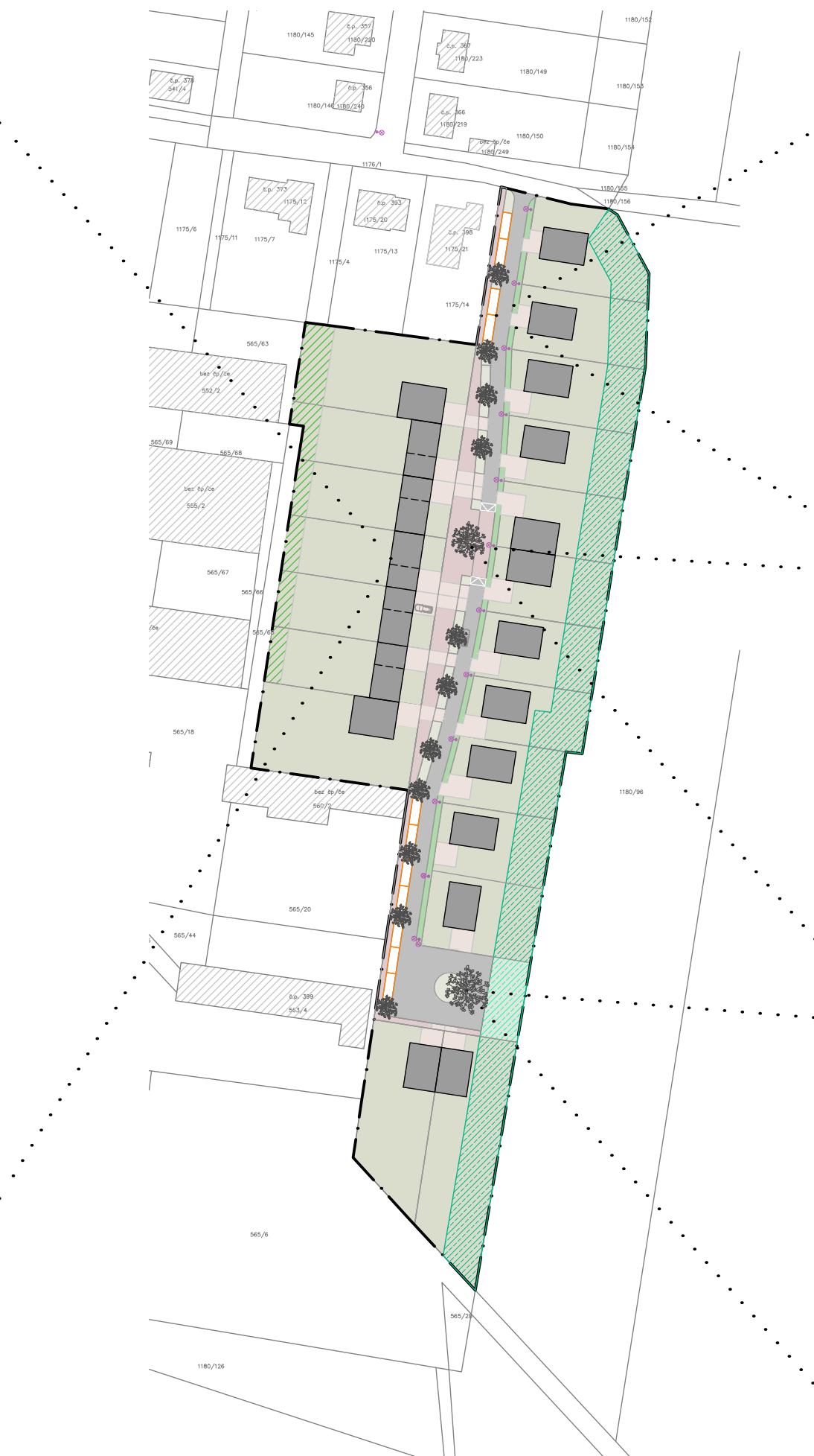
Možné řešení vsakovací dlažby v místech parkovacích stání
